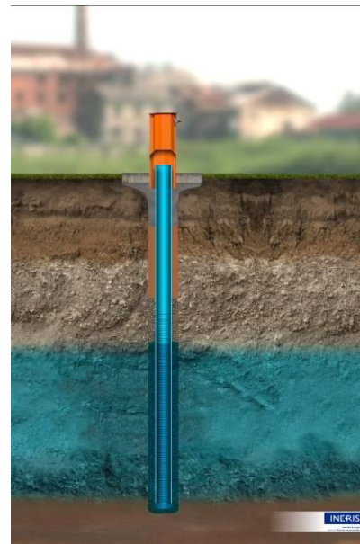
Figure 4 : Aquifère à nappe captive (seconde nappe depuis la surface du sol, indiquée par la flèche).
