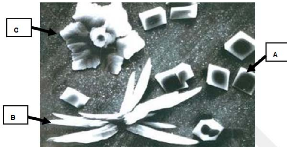
Figure 4 : Différentes formes cristallines du carbonate de calcium (Ledion, Baron et Leroy, 2000). A : calcite, B : aragonite, C : vaterite.
